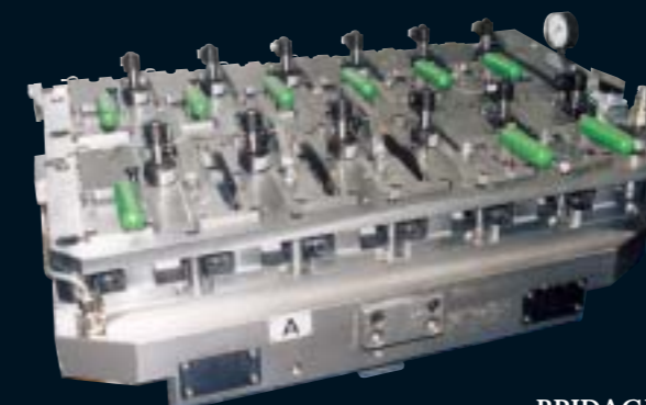
BRIDAGE HYDRAULIQUE MULTI-PIECES SUR PALETTE Hydraulic multiple component clamping on pallet/Mehrstückhydraulikspann-vorrichtung auf Palette
