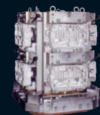
BRIDAGE MANUEL MULTI-PIECES SUR PALETTE Manual multiple component clamping on pallet Mehrstückhandspann-vorrichtung auf Palette
