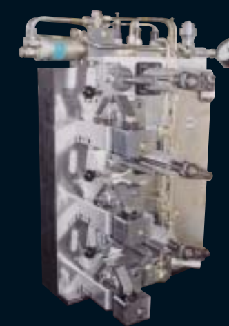
BRIDAGE HYDRAULIQUE MULTI-PIECES SUR PALETTE Hydraulic multiple component clamping on pallet/Mehrstückhydraulikspann-vorrichtung auf Palette
